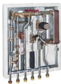
METRO system 2 Slimline er en ultratynd, væghængt unit med gennemstrømningsvandvarmer samt direkte fjernvarme til rumvarme. For at overholde DS469 kræves styring af fremløbstemperatur til rumopvarmning på anlægget.
