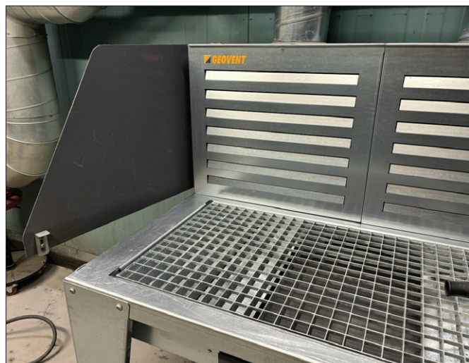
GT Ultra Svejse- og slibebord leveres med svingbart sidepanel
