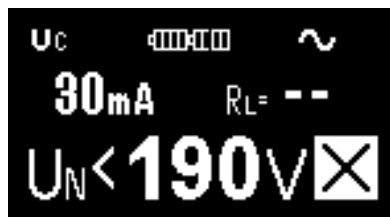
Fig. 3.8 Exempel på inställningar för beröringsspänningsmätning
