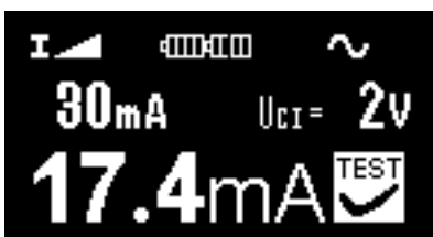
Fig. 3.16a Fasespænding er ikke til stede på testpindene
