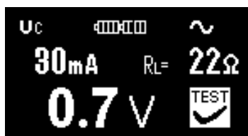
Fig. 3.10 Exempel på beröringsspänning mätresultat
