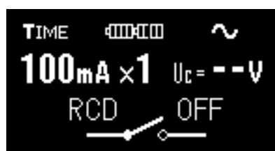
Fig. 3.5 Exempel på JFB som löst ut under test av beröringsspänning.
