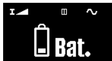
Fig. 3.6b Lav batteri efter tryk på START knappen
