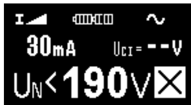
Fig. 3.14 Eksempel af opsætning for måling af udkoblingsstrømmen
