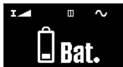
Fig. 3.6b Lågt batteri efter tryck på START knappen
