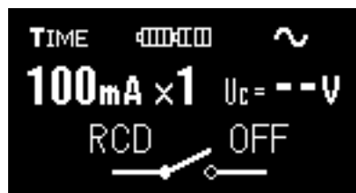
Fig. 3.5 Eksempel af RCD udkobling ved visning af berøringspænding.
