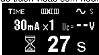
Fig. 3.13 Exempel på nedräkning för selektiva reläer
