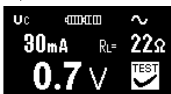
Fig. 3.10 Eksempel på berøringspænding måleresultat
