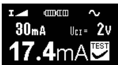
Fig. 3.15a Exempel på mätresultat för fränkopplingsströmmen
