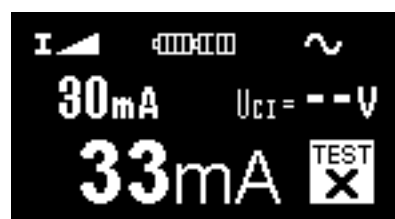
Fig. 3.15b Exempel på mätresultat – JFB fränkopplar inte
