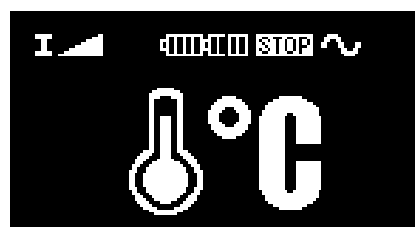
Fig. 3.7b Høj temperatur efter tryk på START knappen
