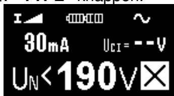
Fig. 3.14 Exempel på inställning för mätning av frångkopplingsströmmen
