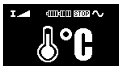
Fig. 3.7b Hög temperatur efter tryck på START knappen
