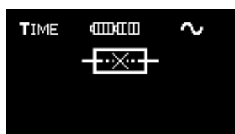
Fig. 3.2 Symbolen för en trasig säkring
