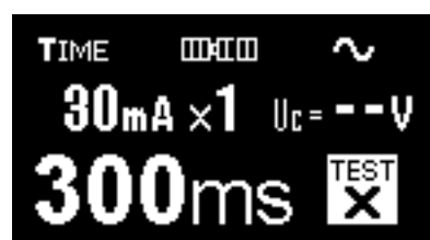
Fig. 3.12b Exempel på mätresultat – JFB frångkopplar inte
