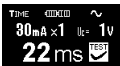
Fig. 3.12a Exempel på mätresultat för frångkopplingstiden
