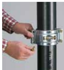
Växeldra de två bultarna med exempelvis en spärrnyckel. Åtdragningsmoment min 20 Nm.
