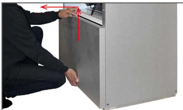
5. Nederste frontplade afmonteres på samme måde som øverste, ved først at løfte pladen og dernæst vippe den ud.
