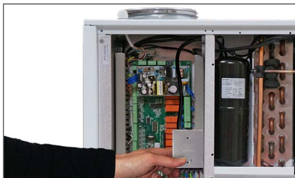
7. Montér strømforsyningsboksen i kassen for automatik i aggregatet (forbor 2 huller til de to medfølgende skruer)
