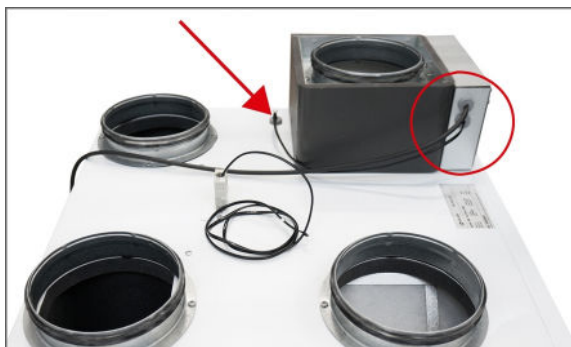
5. Temperaturføleren for forvarmebladen skubbes 8 cm ned i tyllen. Herefter kan den inde i aggregatet ses hængene lige over udeluft filteret.
