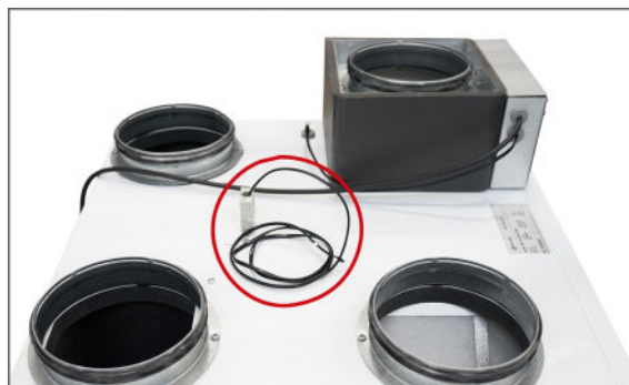
6. T1 føleren trækkes fra 8-pol stik ud i udeluft kanalen (30 cm før forvarmeblade).
