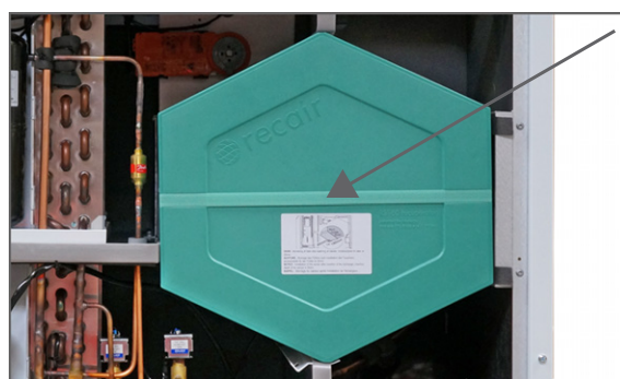
2. Afmonter krydsveksler ved at trække i stroppen (må ikke klippes over).
